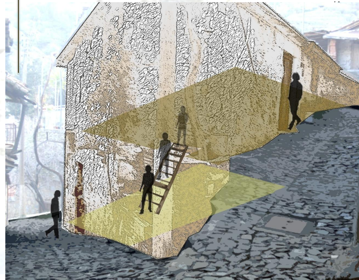
Πρόσβαση στο κάτω επίπεδο μέσω δημόσιου δικτύου λόγω της κλίσης του δρόμου ή μέσω ιδιωτικής εσωτερικής
