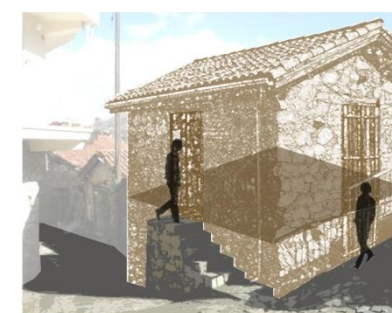
Εικόνα 6: Απουσία εσωτερικής ένωσης των επιπέδων του σπιτιού
